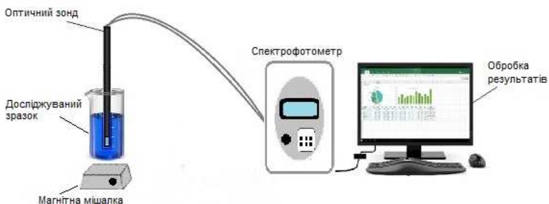
Рис. 1. Схематичне зображення безекстракційних спектрофотометричних досліджень за допомогою оптичного зонду.
